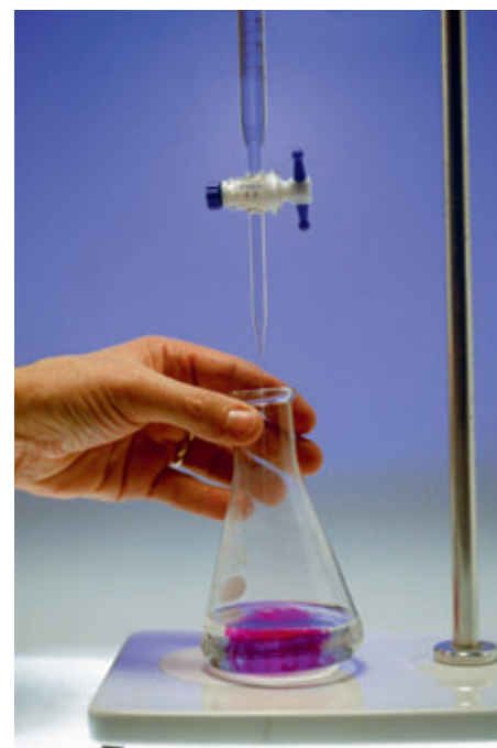
↑ Reacción de neutralización del ácido clorhídrico por titulación.
