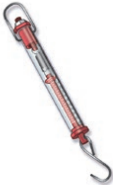
Dinamómetro con resorte de tracción interno.
