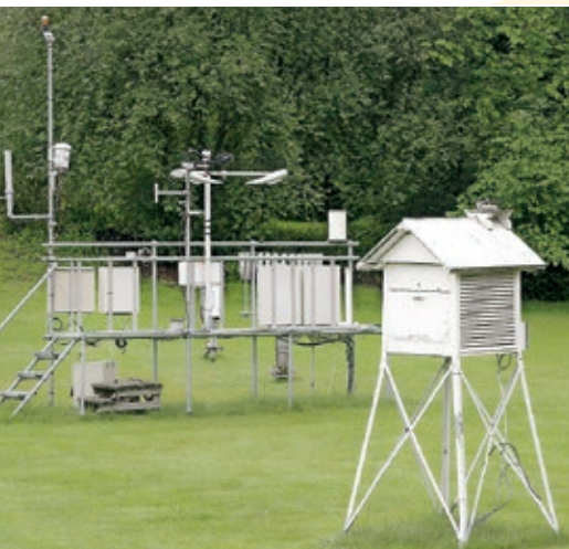
▲ Estación meteorológica, instalación que cuenta con instrumentos que permiten medir la temperatura, la humedad del aire, la presión atmosférica y otras variables.
