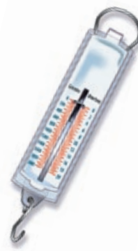
Dinamómetro con resorte de tracción externo.
