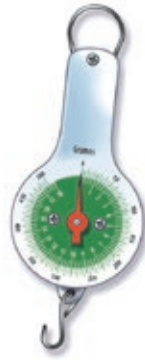
Dinamómetro a base de resorte de torsión.
